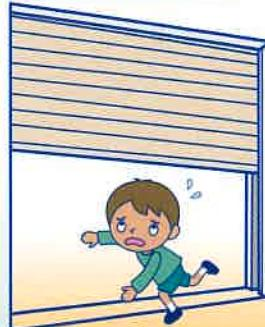
② シャッターアンダーブレーキが検知するとブレーキが復旧しシャッターは停止します。
